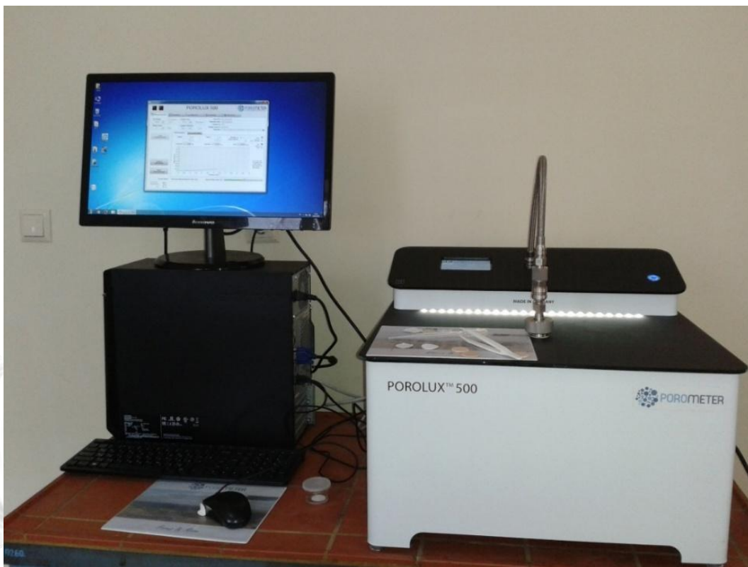
სურათი 43. ფორომეტრი Porolux™ 500 მემბრანების ფორების ზომისა და განაწილების განსაზღვრისათვის.
