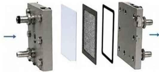
სურათი 47. ლაბორატორიული ფილტრაციული უჯრედი და მისი ძირითადი კონსტრუქციული ელემენტები: 1. ფუძე; 2. სახურავი; 3. ფოროვანი საფენი; 4. ბადე; 5. მემბრანა ; 6. ჰერმეტიკული საფენები.
