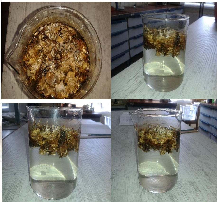
სურათი 32. მზესუმზირის გვირგვინი, როგორც ბუნებრივი სორბენტი ნავთობპროდუქტებით დაბინძურებული წყლის გასაწმენდად.
