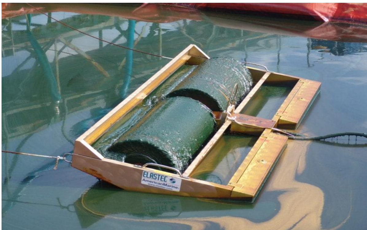
სურათი 3. დაღვრილი ნავთობის მექანიკური შეგროვება მცურავი სკიმერების გამოყენებით
