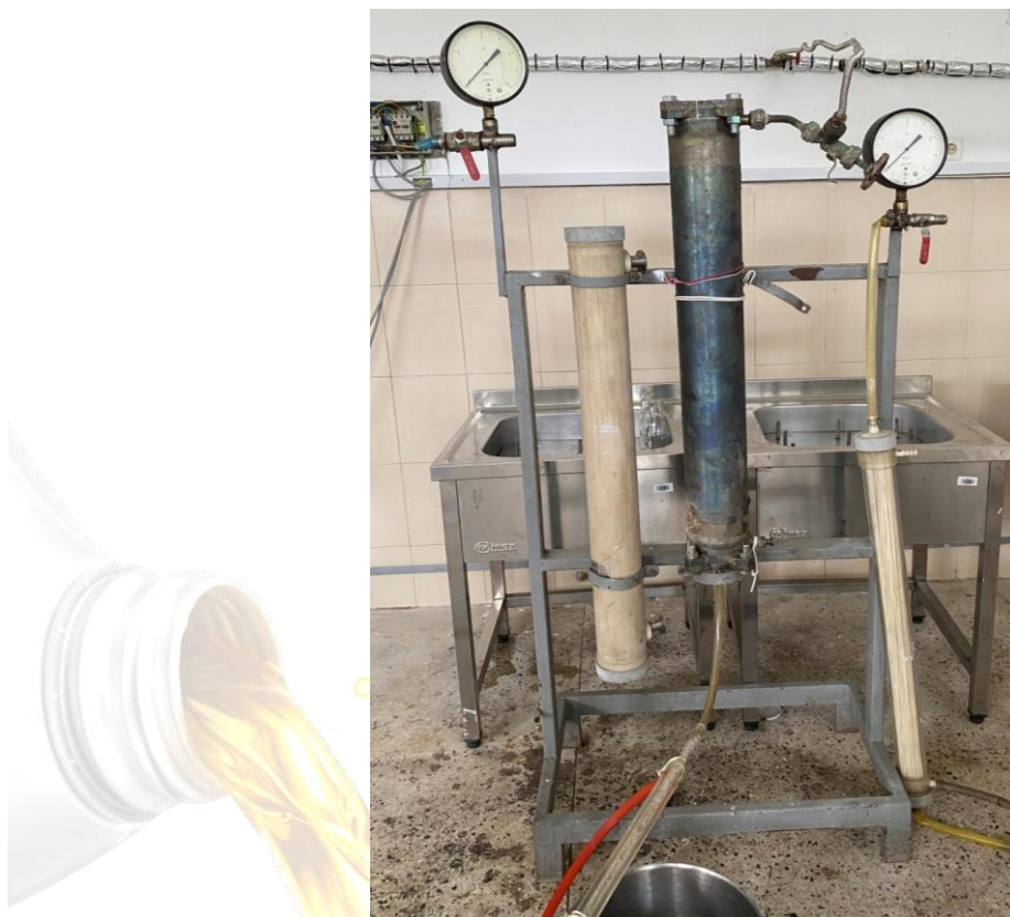
სურათი 34. ნახერხის მაღალი წნევის ორთქლით აქტივაციის ექსპერიმენტული მოწყობილობა.
