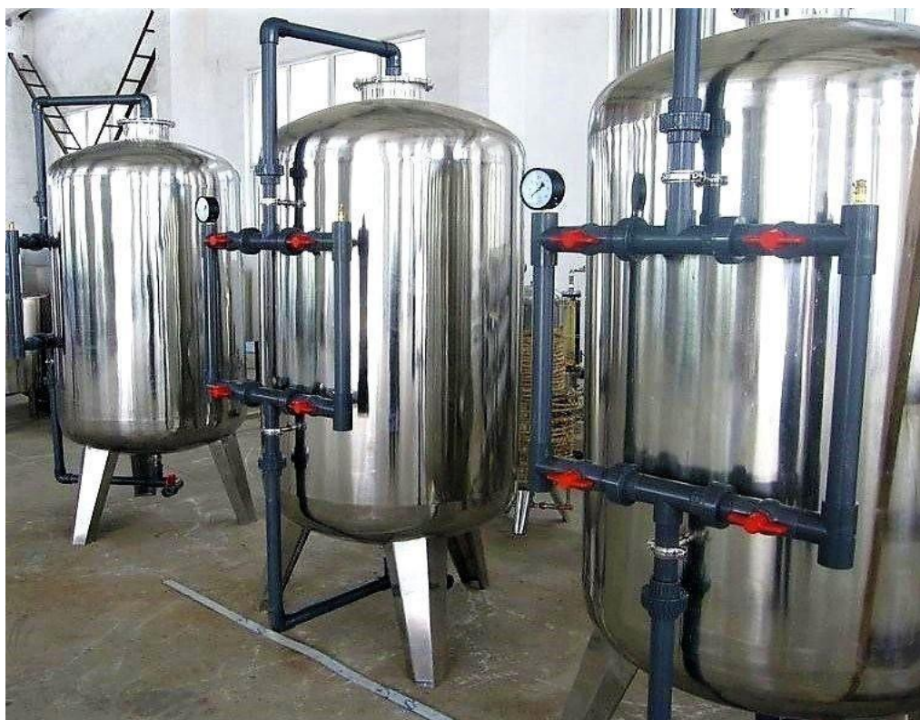
სურათი 14. ნავთობპროდუქტებით დაბინძურებული წყლის მრავალსაფეხურიანი გაწმენდის სისტემა სორბენტების გამოყენებით
