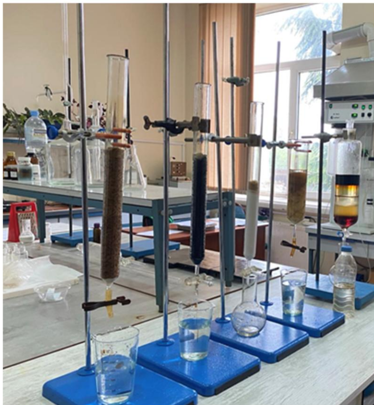
სურათი 39. სორბციული სვეტები ნავთობპროდუქტებით დაბინძურებული წყლების გასაწმენდად.
